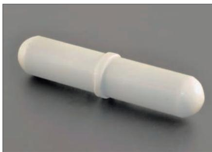
Un agitador magnético (también llamado pulga, frijol o bala magnética) es una pequeña barra magnética (barra de agitación), normalmente cubierta de plástico u otro polímero (Teflón) y una placa debajo de la cual se crea un campo magnético rotatorio.
