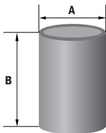
Son una clase imán de Álnico con un armazón de acero. Este tipo de Bases, están imantadas en una cara, dejando el resto libre de campo magnético y al estar protegidas se evita el riesgo de rotura o agrietamiento.
