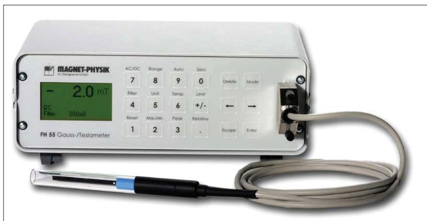
El medidor de Fuerza de campo magnético FH 55 es un instrumento compacto de precisión que mide densidad de flujo magnético y la Fuerza de campo en Tesla (T), Gauss (G) o Amperio por metro (A/m). El instrumento se suministra con una cámara de campo cero y un manual de operación en lengua inglesa.
