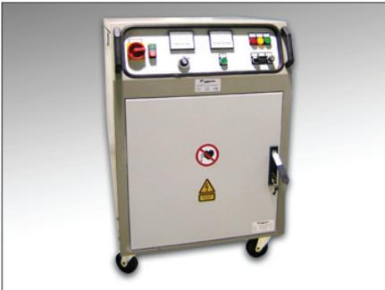
Este sencillo equipo, está preparado para imantar cualquier tipo de Imán de Ferrita y de Álnico. Se pueden realizar imantaciones de Sistemas Magnéticos ya montados. Satura perfectamente los motores de c/c, que existen en el mercado. Se le puede acoplar cualquier tipo de bobina acorde a sus necesidades y calibrar la descarga que se realice sobre ésta. Puede acoplarse a un Gausómetro para poder hacer la lectura del campo después de la imantación. Dicho aparato es muy versátil y muy eficaz.
