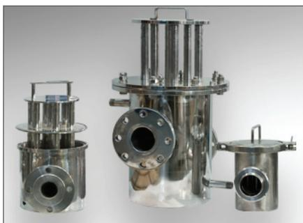
Estos filtros magnéticos se utilizan para la filtración de partículas de hierro de productos en forma líquida. Se usan también de manera muy frecuente en circuitos hidráulicos y sistemas de refrigeración. Este tipo de sistemas magnéticos están contruidos en acero inoxidable (AISI 304/316) haciendo posible la utilización del mismo para industria alimentaria.
