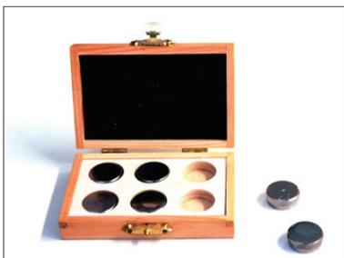
Conjunto de 6 bases magnéticas de Calidad Neodimio Ø20\*8 mm. con carcasa de hierro cromado, presentado en un estuche de madera. Se utilizan en máquinas de electroerosión, para sostener la parte erosionada al final del proceso para impedir una eventual ruptura del hilo.
